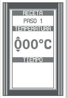
La selección de parámetros del PASO 2 se lleva acabo de la misma forma que la selección de parámetros del PASO 1. Y una vez seleccionados y almacenados los parámetros del PASO 2 se deben seleccionar los del PASO 3. En caso de que se desee que la receta solo conste del PASO 1 lo que se debe de hacer es seleccionar una temperatura de 0°C en el PASO 2, y, si lo que se quiere es que la receta solo tenga PASO 1 y PASO 2 se debe de seleccionar una temperatura de 0°C en el PASO 3.
